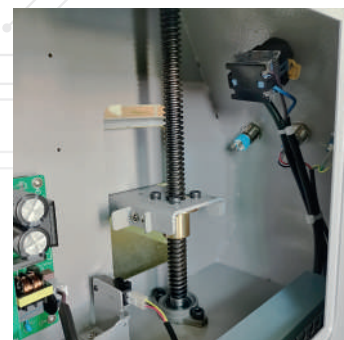
Tornillo reforzado sube y baja
