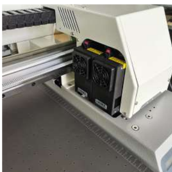
Doble sistema para enfriamiento de lámparas
